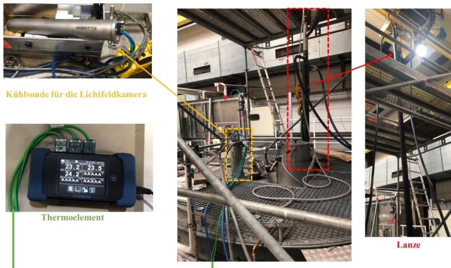
**Abbildung 70.** Bilder von den in der Brennkammer durchgeführten Experimenten. Die Lichtfeldkamera wird durch eine Kühlsonde gekühlt. Die oben in der Brennkammer installierte Sonde ist mit einem gelben gestrichelten Rechteck gekennzeichnet. Die aktuelle Temperatur innerhalb der Kühlsonde wird durch das Thermoelement auf der linken Seite gemessen und angezeigt. Eine höhenverstellbare Lanze ist markiert mit einem rot gestrichelten Rechteck.
