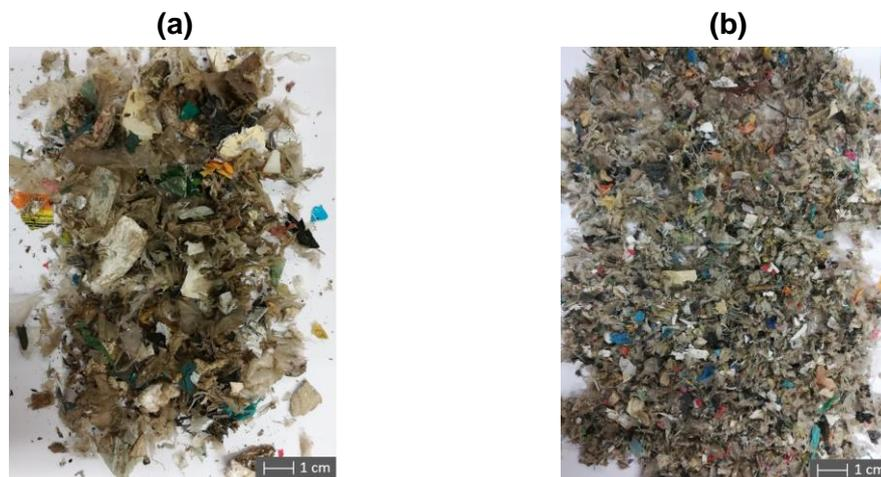
**Abbildung 68.** FLUFF in geliefertem Zustand (a) und zerkleinert (b).
